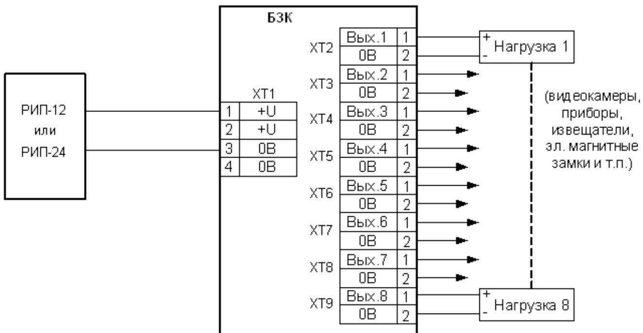
Схема параллельного подключения БЗК
