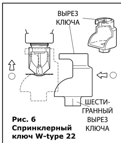
**Рис. 6. Спринклерный ключ W-type 22**
