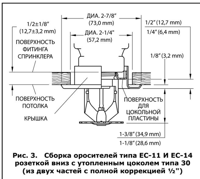
**Рис. 3. Сборка оросителей типа ЕС-11 и ЕС-14 розеткой вниз с утопленным цоколем типа 30 (из двух частей с полной коррекцией 1/2")**
