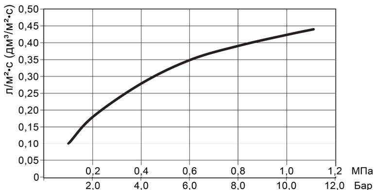
**Рис. 8с** График зависимости интенсивности орошения оросителей от давления для оросителя ТУ6137 (ЕС-14) (ГОСТ Р 51043-2002)
