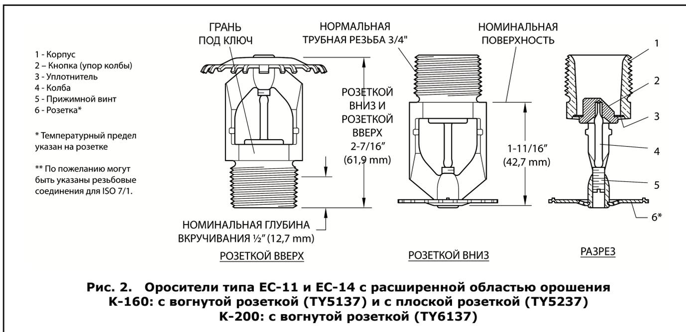
**Рис. 2. Оросители типа ЕС-11 и ЕС-14 с расширенной областью орошения К-160: с вогнутой розеткой (TY5137) и с плоской розеткой (TY5237) К-200: с вогнутой розеткой (TY6137)**
