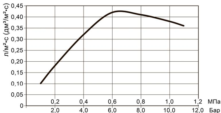
**Рис. 8а** График зависимости интенсивности орошения оросителей от давления для оросителя ТУ5137 (ЕС-11) (ГОСТ Р 51043-2002)
