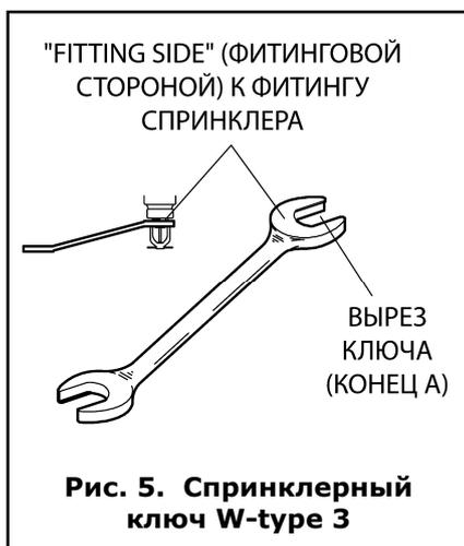
**Рис. 5. Спринклерный ключ W-type 3**
