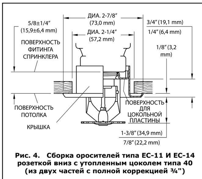
**Рис. 4. Сборка оросителей типа ЕС-11 и ЕС-14 розеткой вниз с утопленным цоколем типа 40 (из двух частей с полной коррекцией 3/4")**
