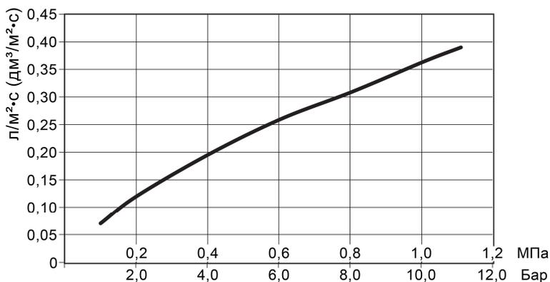
**Рис. 8б** График зависимости интенсивности орошения оросителей от давления для оросителя ТУ5237 (ЕС-11) (ГОСТ Р 51043-2002)
