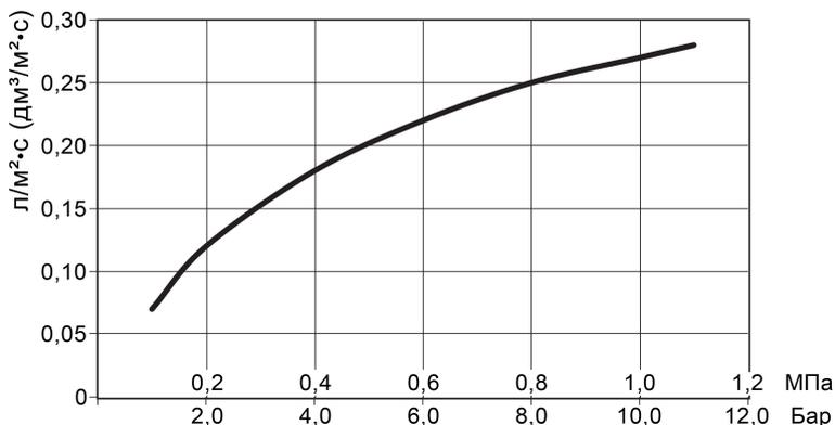
**Рис. 8д** График зависимости интенсивности орошения оросителей от давления для оросителя ТУ6237 (ЕС-14) (ГОСТ Р 51043-2002)
