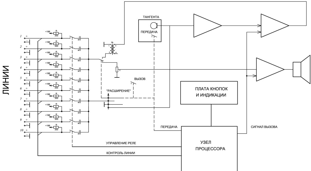
В состав блока входят плата коммутации (с выходными реле), плата кнопок и индикации и плата процессора. К каждой линии связи подключен балластный резистор, который определяет уровень тока через АУ. При работе микрофона АУ, на нем выделяется звуковое напряжение.
