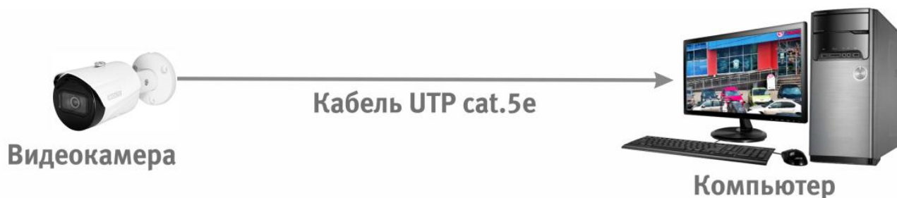
Рисунок 6.2 — Схема подключения видеокамеры к компьютеру
