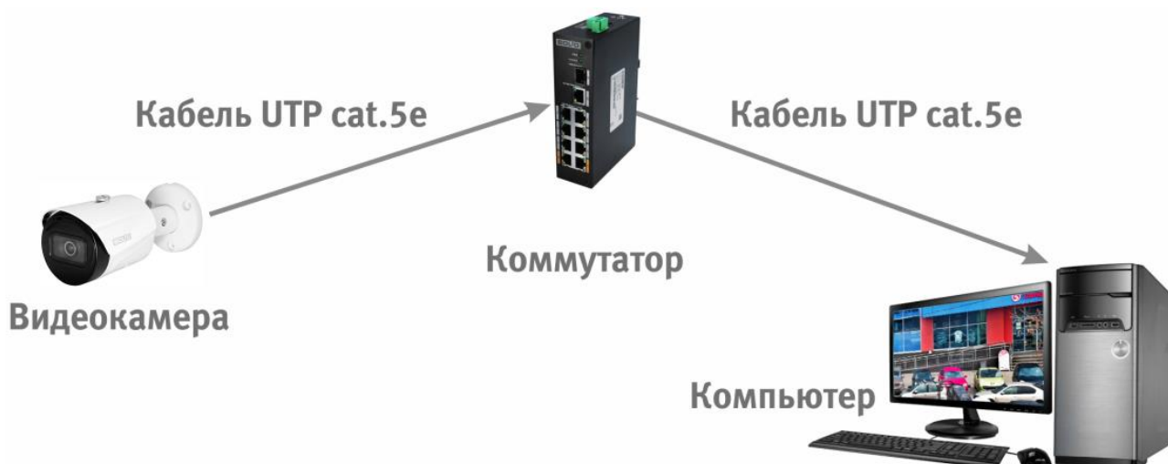
Рисунок 6.3 — Схема подключения видеокамеры к компьютеру через коммутатор
