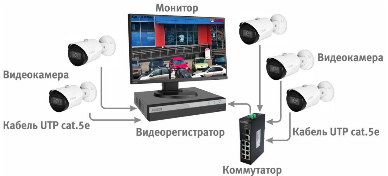
Рисунок 6.4 — Схема подключения видеокамеры к видеорегистратору
