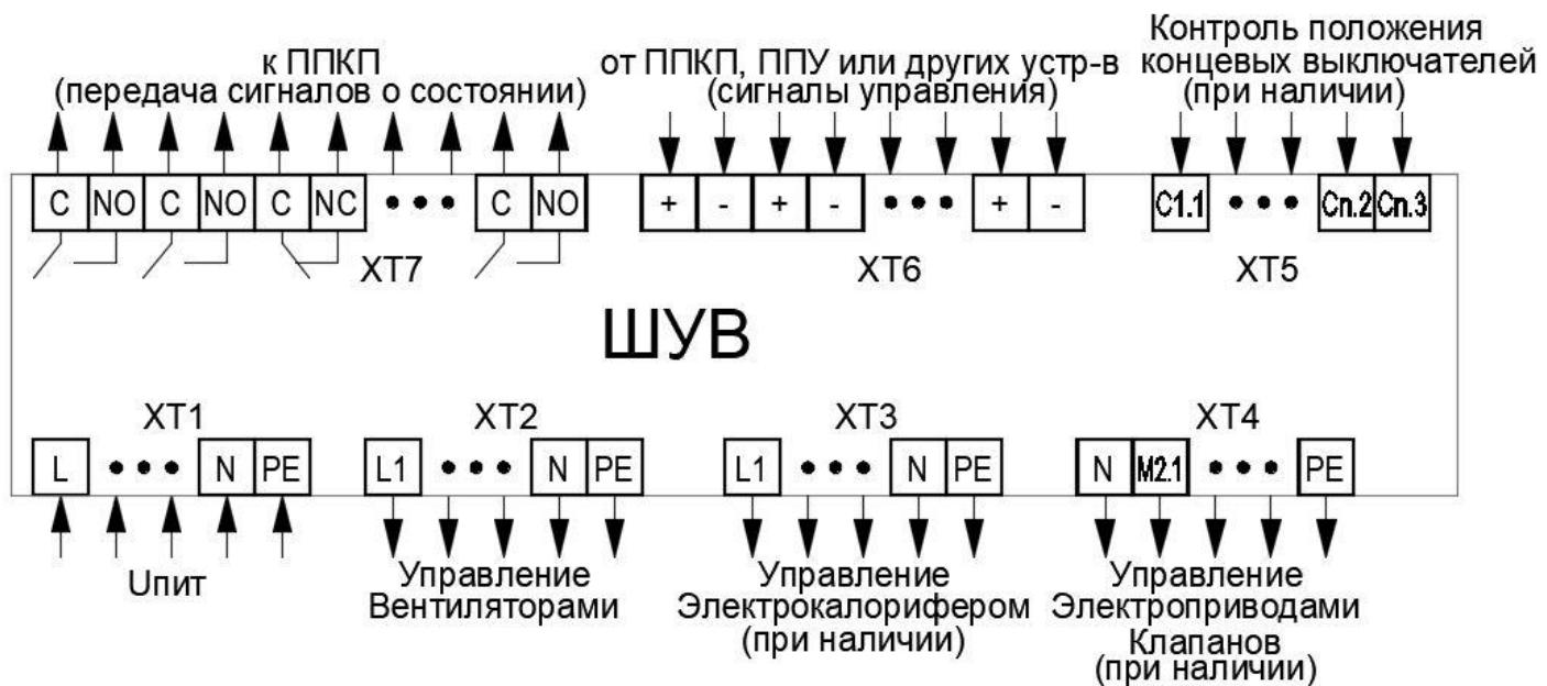
Схема внешних подключений каждой конкретной модификации изображена на внутренней стороне двери каждого ШУВ.
