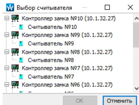
4. В открывшемся окне выделите считыватель, для которого необходимо создать точку верификации. Нажмите кнопку **OK**. Если считыватель уже присутствует в конфигурации, то кнопка **OK** будет недоступна. Окно **Выбор считывателя** будет закрыто, выбранный считыватель будет добавлен в список в окне **Конфигурация верификации**. При необходимости считыватель можно удалить с помощью кнопки **Удалить считыватель**.
