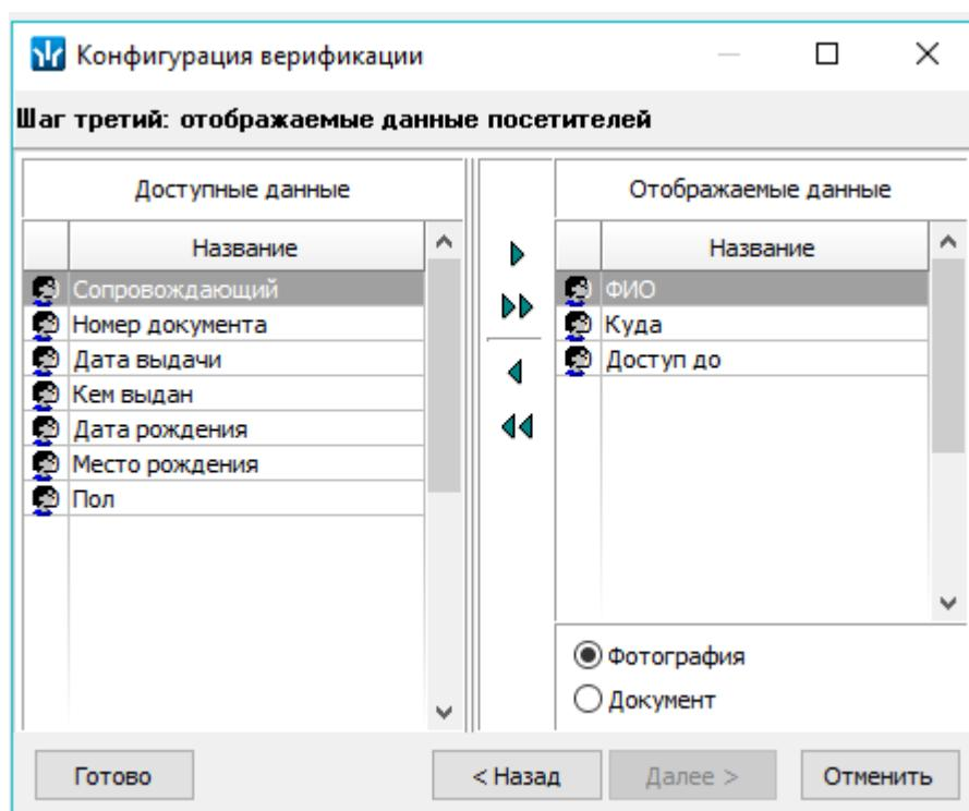
12. Определите, какие данные должны отображаться в таблице данных рабочего окна раздела при верификации карты доступа посетителя. Для выбора данных выделите их в столбце **Доступные данные** и при помощи стрелок, расположенных в центральной части окна, перенесите в столбец **Отображаемые данные**. Установите флажок у параметра **Фотография** или **Документ** для отображения фотографии посетителя или скана его документа. Нажмите кнопку **Готово**.
