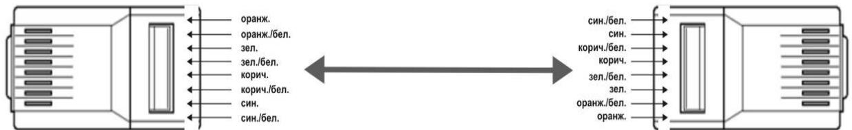
Рис. 4. Схема подключения вилки RJ45
