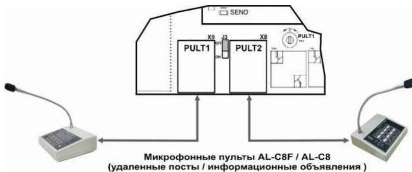
Рис. 3. Пример подключения
