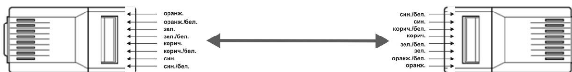
Рис. 4. Схема подключения вилки RJ45
