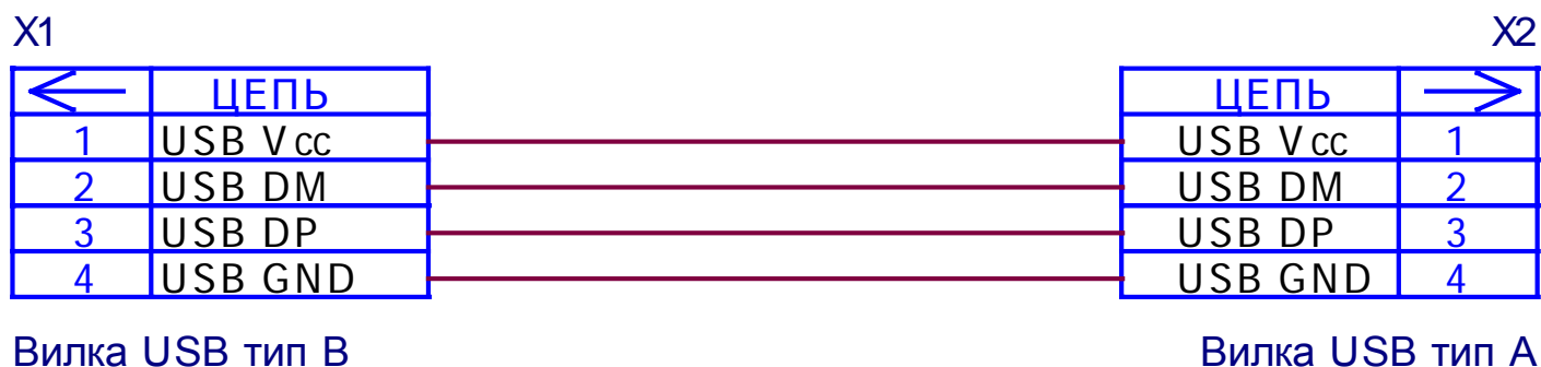
Рис. 5. Схема кабеля USB-AB
