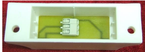
ДПМ-2 исп.03/2 клеммы экспрессмонтажа, Wago
