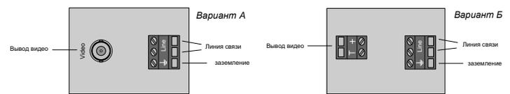
Настройка видеотрансмиттера на линию не требуется. При получении на экране монитора, не синхронизированного негативного изображения, следует поменять местами включение проводов линии на входе приемника RX.
