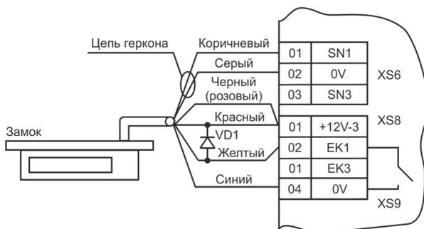
Использовать защитный диод VD1 марки 1N4007, или аналогичный по характеристикам. Монтаж диода осуществлять на контакты замка, а не контроллера!
