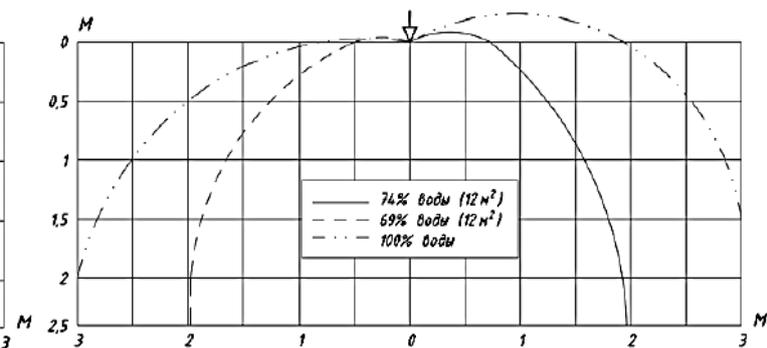
**График зависимости интенсивности орошения от давления на площади 12 м<sup>2</sup>, защищаемой одним оросителем с высоты 2,5 м**
