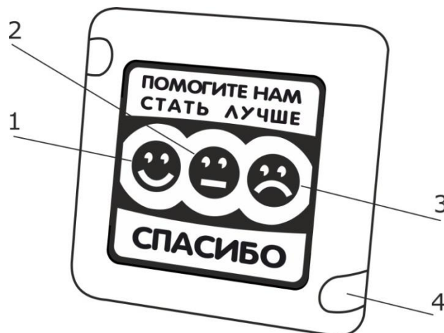
Рисунок 1. Внешний вид радиокнопки МР-411Q3
