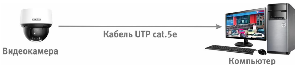
Рисунок 6.2 – Схема подключения видеокамеры к компьютеру
