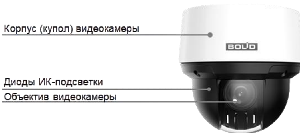
Рисунок 4.1 – Внешний вид и основные элементы видеокамеры
