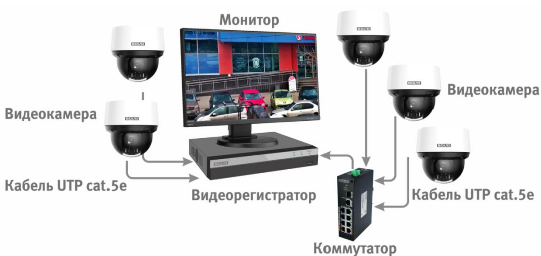
Рисунок 6.4 – Схема подключения видеокамеры к видеорегистратору
