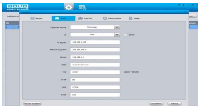
Рисунок 8.2 – Изменение IP-адреса видеочамеры с помощью утилиты «BOLID VideoScan»
