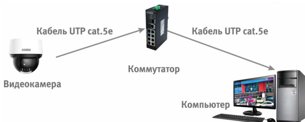
Рисунок 6.3 – Схема подключения видеокамеры к компьютеру через коммутатор
