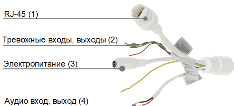
Рисунок 6.1 – Группы концевой раскладки кабеля видеокамеры
