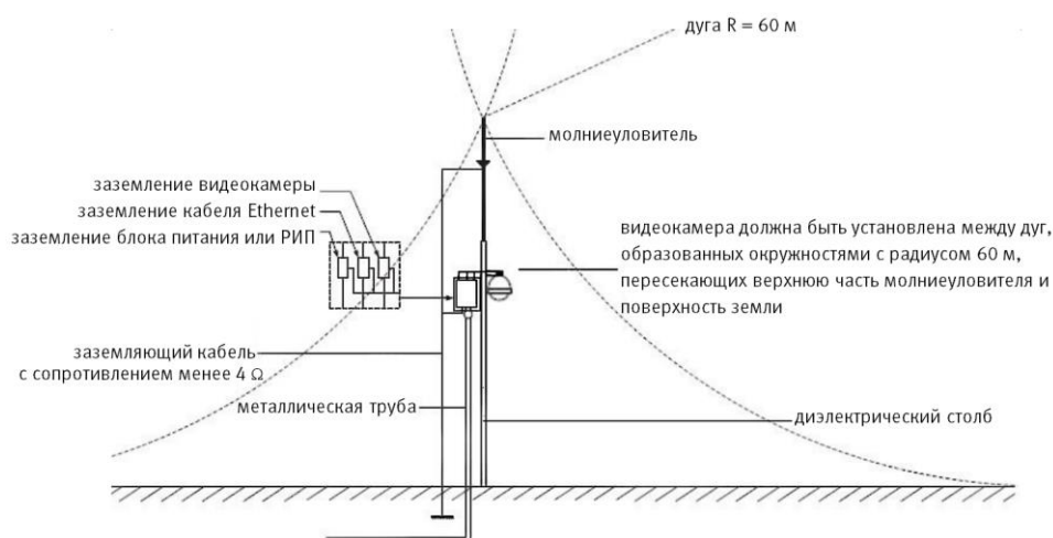
Рисунок 6.12 — Установка молниеотвода
