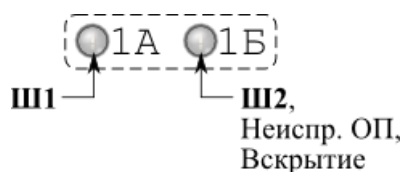
Рис. 3: Индикация состояний прибора управления или прибора пожарной сигнализации «Мастер-02+», настроенного на работу по одному адресу
