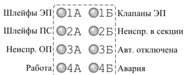
Рис. 5: Индикация состояния секции жилого дома на центральном пульте «Мастер-Ц+»
