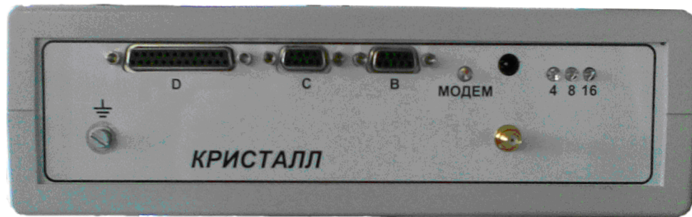
Рис. 2. Расположение разъемов на блоках СДК- 31.x15
