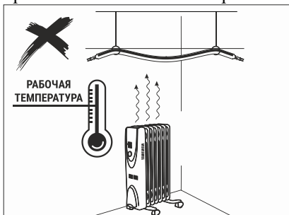
Рис. 7 – Запрещается превышать максимальную рабочую температуру эксплуатации ЧЭ на объекте.
