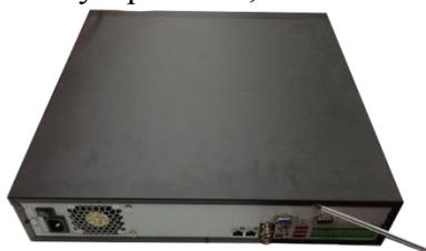
1. Удалите винты задней панели с помощью отвертки и снимите переднюю крышку.
