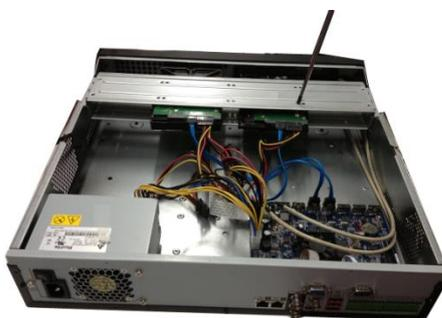
2. Поместите жесткий диск в кронштейн на корпусе и затем совместите четыре отверстия на корпусе с отверстиями на диске. С помощью отвертки тщательно завинтите винты, чтобы закрепить жесткий диск на кронштейне
