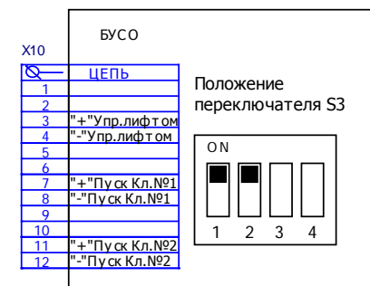
Назначение контактов разъёма X10 при отсутствии управления вентиляторами
